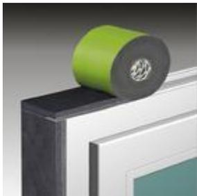
Fig 3 : Incollare TP652 sul telaio (con lato grigio verso l'interno). I segmenti orizzontali devono ricoprire i montanti verticali.
