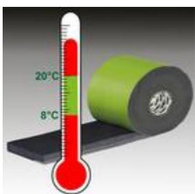
Fig 4 : Stoccaggio e applicazione idealmente tra 8°C e 20°C. Temperature elevate accelerano la decompressione, basse temperature la rallentano
