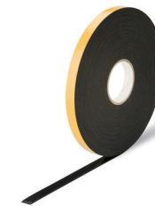
Ova traka je vrlo učinkovita traka za sigurnosno ostakljivanje, koja je osmišljena kako bi poboljšala sigurnost prozora i vrata sa pričvršnim letvicama. Proizvod se upotrebljava kao zamjena za uobičajeno unutarnje brtvljenje, pri čemu se jedinica stakla spaja s okvirom i zapečaćuje. Kod ispravnog odabira i nanošenja proizvoda je uklanjanje jedinice izvana gotovo nemoguće bez uništenja.
