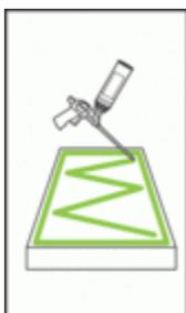
Appliquer la colle isolation PU010 illbruck sur l'arrière du matériau isolant à coller.
