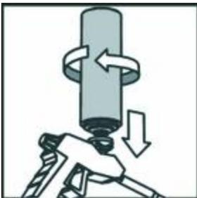
Retirer la protection et visser la bonbonne, avec la soupape vers le bas, dans l'adaptateur du pistolet, la lance loin de vous.
